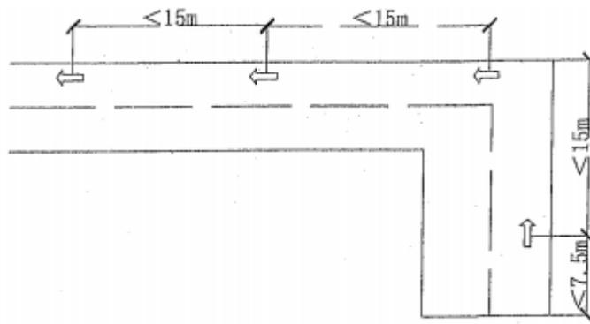
图 12 疏散照明和疏散诱导灯设置位置
