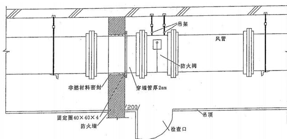
图 10 防火阀检修口设置示意图
