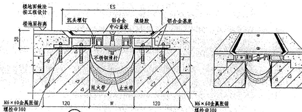
图 7 变形缝构造示意图
